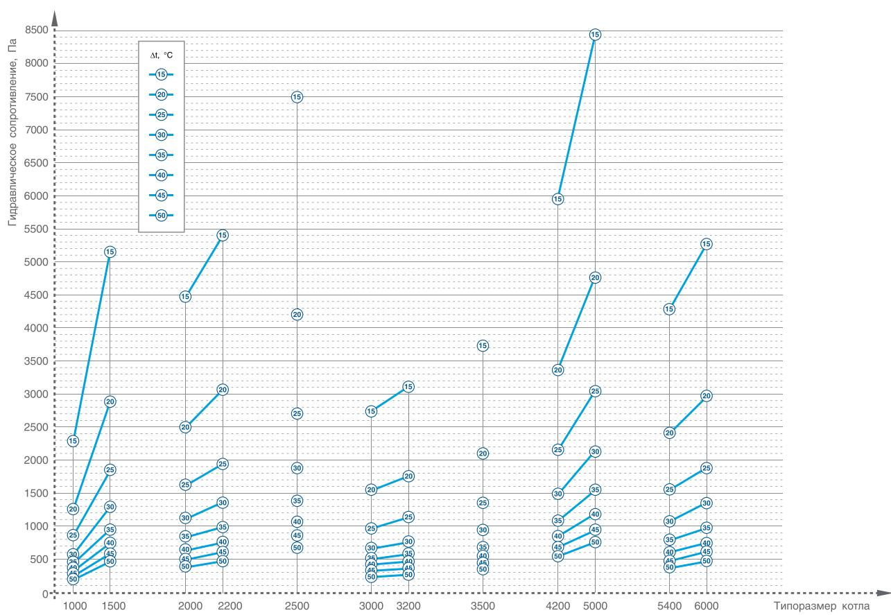
Зависимость гидравлического сопротивления котлов TT100 от  $\Delta t$
