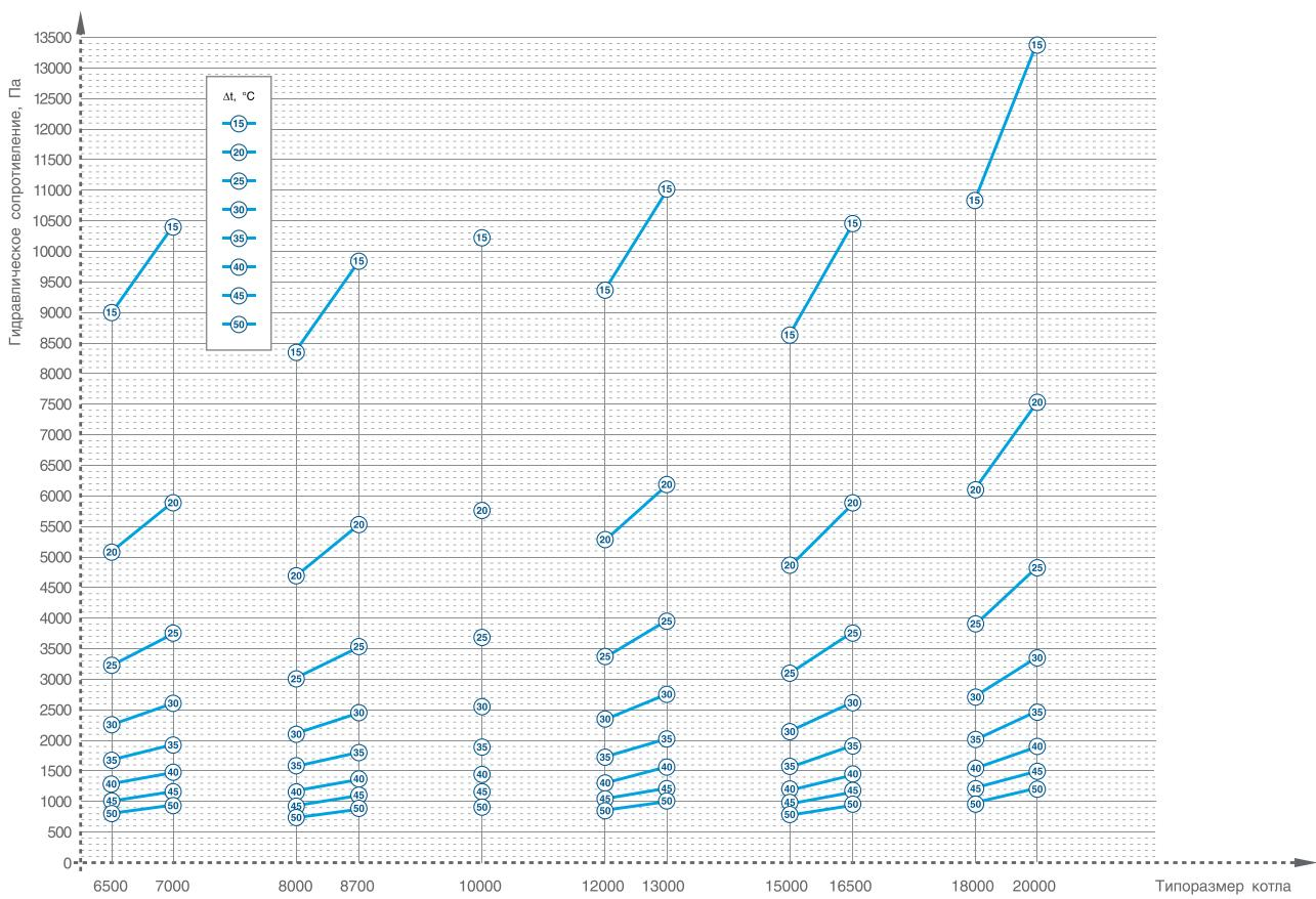
Зависимость гидравлического сопротивления котлов TT100 от  $\Delta t$ . Продолжение
