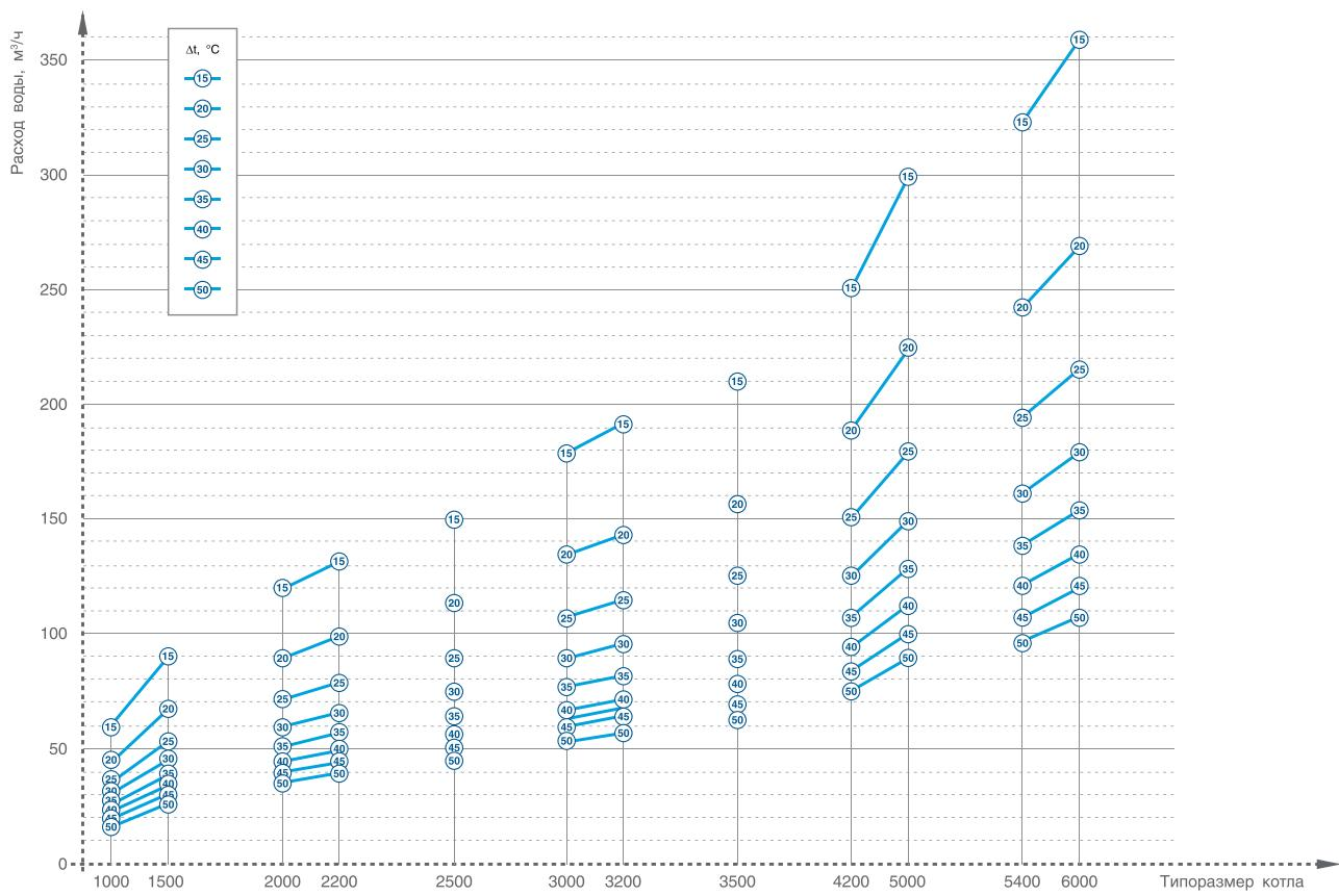
Зависимость расхода воды котлов TT100 от  $\Delta t$
