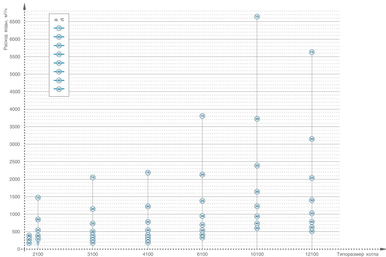
Зависимость гидравлического сопротивления котлов TT100 от  $\Delta t$  (на режиме тепличного хозяйства)
