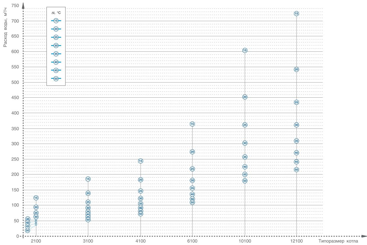
Зависимость расхода воды котлов TT100 от  $\Delta t$  (на режиме тепличного хозяйства)
